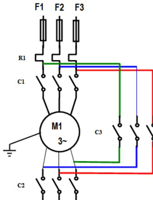
Se os contatores C1 e C2 funcionarem nos primeiros 2 segundos de acionamento do motor e após este intervalo de tempo, C2 for desligado e C3 energizado, mantendo-se em regime permanente, a este acionamento pode ser atribuído o nome:
