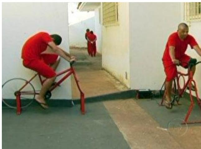
Duas bicicletas ficam no pátio do presídio. Por correias, as pedaladas geram a energia que vai carregar duas baterias. No guidão, um aparelho indica a hora de parar.
